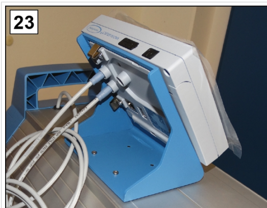
23. Fäst regulatoren på pumpstationen och anslut alla kablar.
