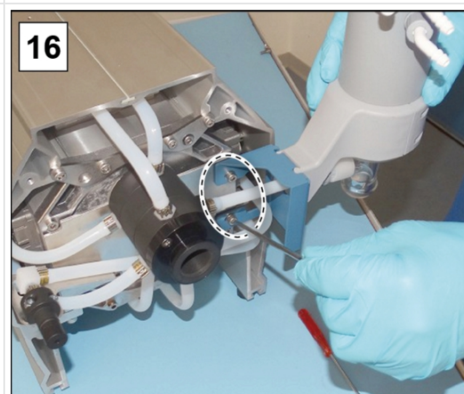
16. Skruva in de 2 skruvarna från EK hållaren; Insexnyckel storlek 4.
