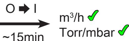
A bomba atinge os valores especificados para a capacidade de sução e o vácuo final bem como a compatibilidade com o vapor (MZ 1C) apenas à temperatura de funcionamento (após aprox. 15 min.).
