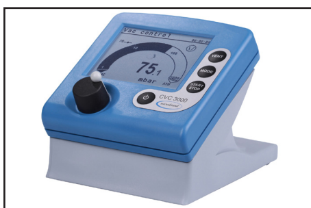
Controller del vuoto CVC 3000 ..... 20683160 100-230 V 50-60 Hz
