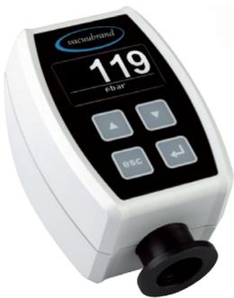
Con sensore a membrana ceramica resistente alle sostanze chimiche per una misurazione precisa nel **campo di basso vuoto**. Secondo il principio di misura capacitivo, la pressione assoluta presente viene rilevata indipendentemente dal tipo di gas.
