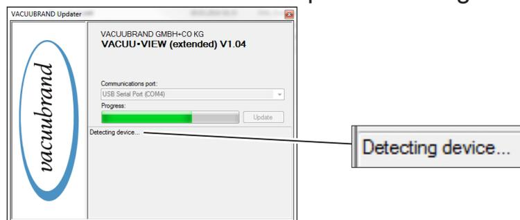
3. Premere il tasto **Enter** sullo strumento di misura entro il tempo in cui viene visualizzata la barra di avanzamento.
