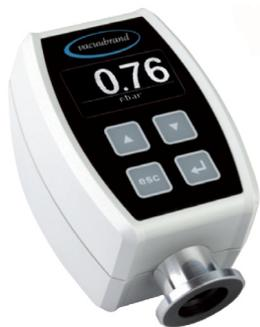
Il misuratore di basso vuoto e vuoto fine sfrutta la combinazione resistente alle sostanze chimiche, costituita dal sensore Pirani rivestito in ceramica e dal sensore con membrana ceramica, per la misurazione dal **campo di vuoto fine al campo di basso vuoto**. Lo strumento di misura fornisce valori di vuoto affidabili nell'intero campo di misura.
