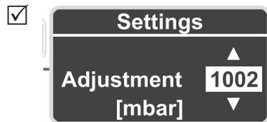
2. Correggere con i tasti **freccia** alla pressione atmosferica esatta secondo lo strumento di misura di riferimento.
