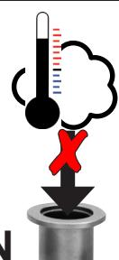
Evitare un forte afflusso di calore (ad es. dovuto a gas di processo caldi). Intervallo di temperature ammesso: vedere "Dati tecnici / Temperature di aspirazione dei gas".
