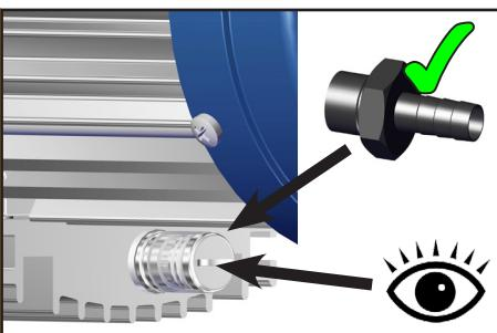
☞ Dopo un funzionamento prolungato con pressioni di aspirazione elevate o gas contenenti polvere, il silenziatore può ostruirsi. Verificare regolarmente il flusso di passaggio nel silenziatore, eventualmente sostituirlo o rimpiazzare con un raccordo ondulato per flessibili.
