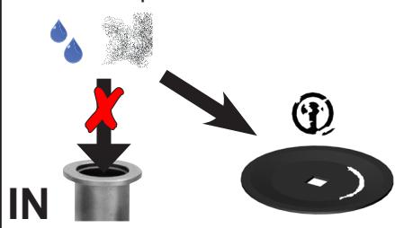
Evitare la condensa nella pompa, come anche colpi d'ariete e polvere, in quanto un trasporto duraturo di liquidi o polvere danneggia membrane e valvole.
