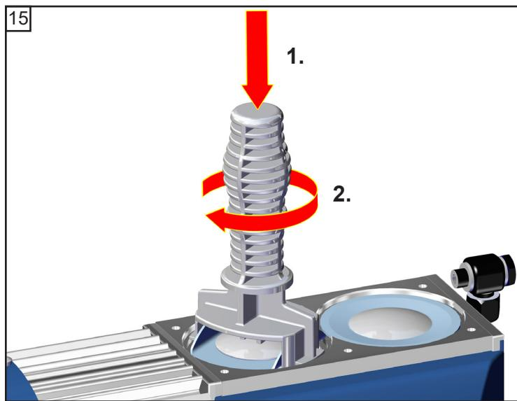
**Sostituzione delle valvole e montaggio delle testate della pompa**
