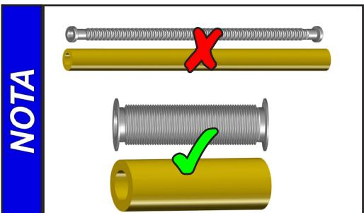
Utilizzare linee di collegamento del vuoto più corte possibili, con grande larghezza nominale, per evitare perdite dalle valvole a farfalla.
