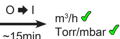
La pompa raggiunge i valori indicati per la potenza di aspirazione e il vuoto finale solo a temperatura di esercizio (dopo circa 15 minuti).
