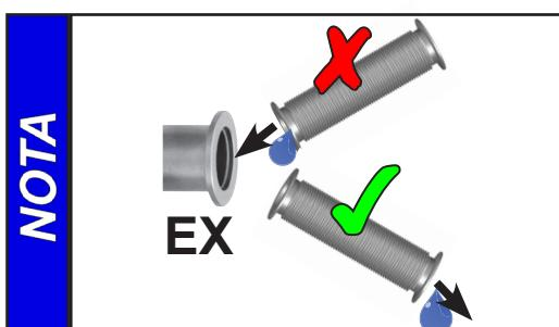
Disporre le linee di scarico sempre in pendenza verso il basso o adottare altre misure per impedire il flusso di ritorno della condensa dalla tubazione di scarico nella pompa.
