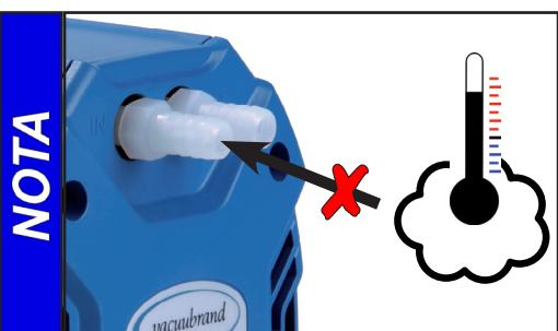
Evitare un forte afflusso di calore (ad es. dovuto a gas di processo caldi). Intervallo di temperatura ammesso: vedere "Dati tecnici / Temperature di aspirazione dei gas".
