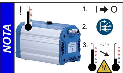
Una **protezione termica dell'avvolgimento a tenuta automatica** spegne il motore in caso di sovratestermperatura. **Attenzione:** è possibile solo il ripristino manuale. Spegnere la pompa o staccare la spina di rete. Rilevare ed eliminare la causa del surriscaldamento. Lasciare raffreddare la pompa a sufficienza.
