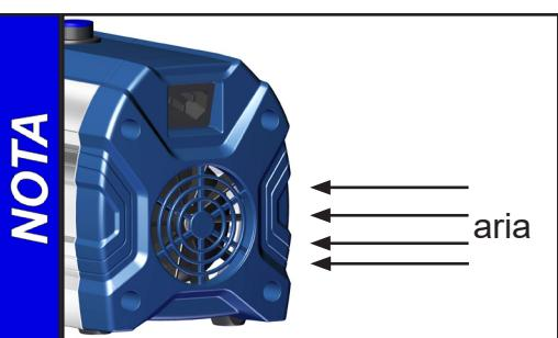
Garantire sempre un apporto sufficiente di aria al ventilatore. Controllare regolarmente la presenza di sporco sul ventilatore. Pulire la griglia del ventilatore sporca per evitare una limitazione di alimentazione dell'aria.
