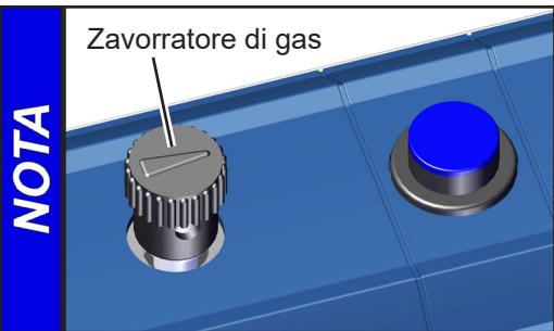
In caso di trasporto di vapori condensabili, azionare la pompa (MZ 1C) con uno zavorrato di gas, al fine di ridurre la condensa delle sostanze pompate (vapore acqueo, solvente,...) all'interno della pompa.
