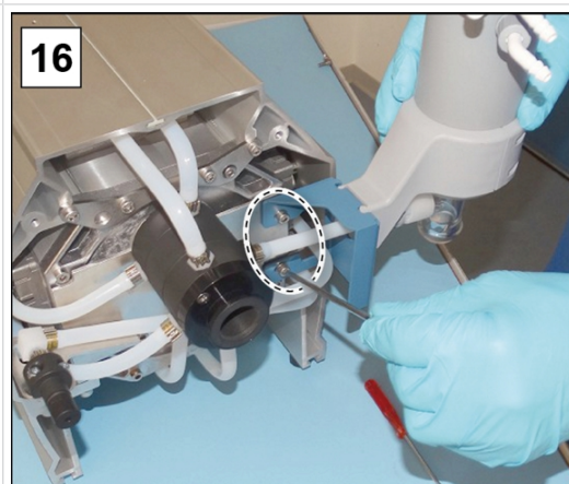
16. Csavarozza ki a 2 csavart az EK-tartóból; 4-es belső hatlapú kulcs.
