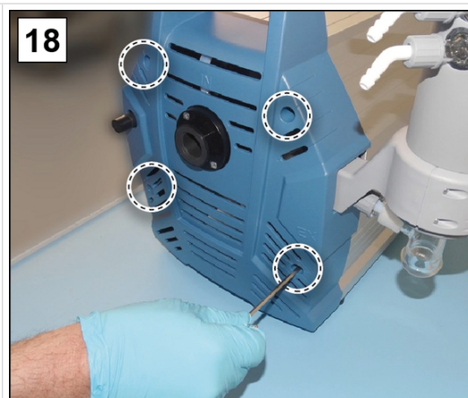
18. Kierrä kotelon osan ruuvit sisään; kuusiokoloavain koko 4.
