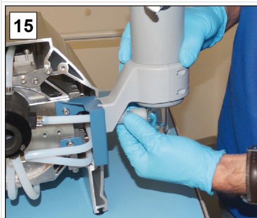
15. Kiinnitä kiristysmutteri EK:n tulopuolella.
