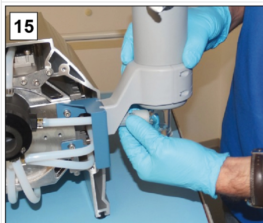
15. Fiksér omløbermøtrikken ved indløb EK.
