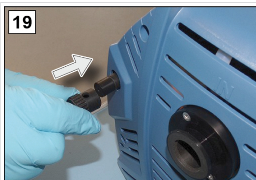
19. Montér kappen på gasballa- sten.
