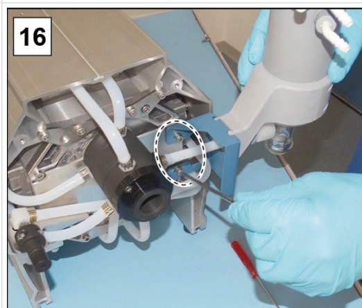
16. Wkręcić 2 śruby uchwyty EK kluczem imbusowym rozm. 4.
