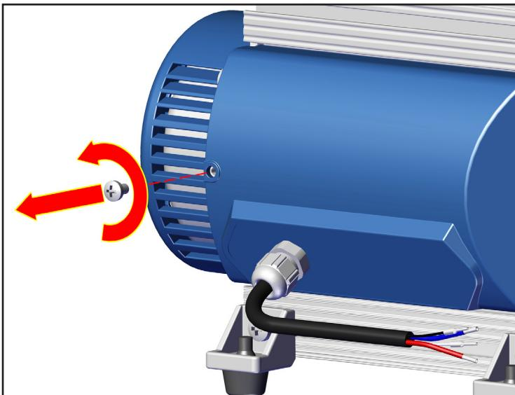
Выкрутить винт на крышке.
