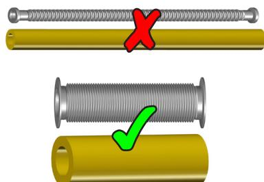
Использовать максимально короткие вакуумные соединительные трубопроводы большого名义ального внутреннего диаметра, чтобы избежать потерь при дросселировании.
