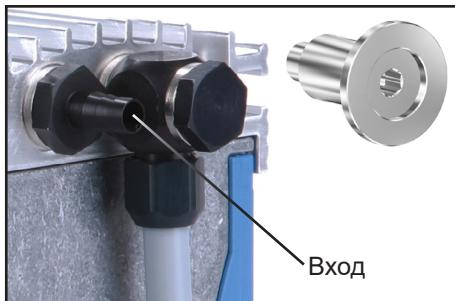
При необходимости заменить ребристый патрубок фланцевым соединением малого диаметра KF DN 16 (резьба G 1/8") (см. «Принадлежности»).
