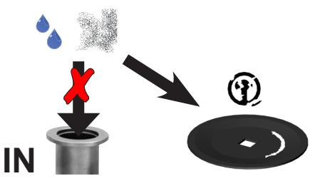
Не допускать образования конденсата в насосе, а также гидравлических ударов и пыли, так как длительная подача жидкостей или пыли приводит к повреждению мембранны и клапанов.
