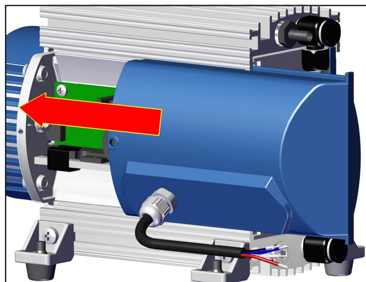
После замены предохранителя снова установить крышку.
