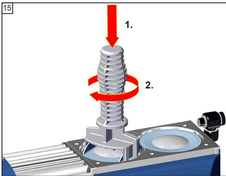
**Замена клапанов и монтаж головок насоса**
