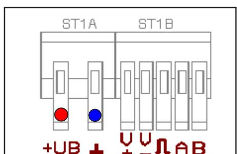
→ Обеспечить отсутствие управляющего сигнала, например, отсоединить белый и черный кабель от блока клемм ST1B.
