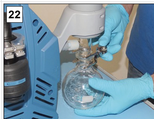
22. Připevněte skleněnou baňku k EK.
