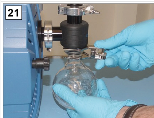
21. Připevněte skleněnou baňku ke vstupu IN.
