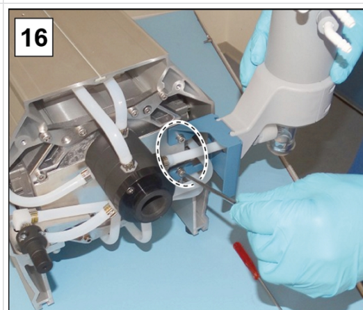
16. 从 EK 支架上拧入 2 个螺栓；4 号内六角扳手。
