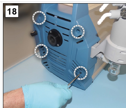
18. 拧入壳体件的螺栓；4 号内六角扳手。
