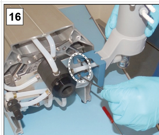
16. Vissez les 2 vis du support EK ; clé à six pans creux T 4.
