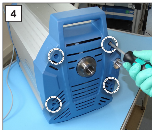
4. Revissez les 4 vis de la partie avant du boîtier à l'aide d'une clé Allen de taille 4.
