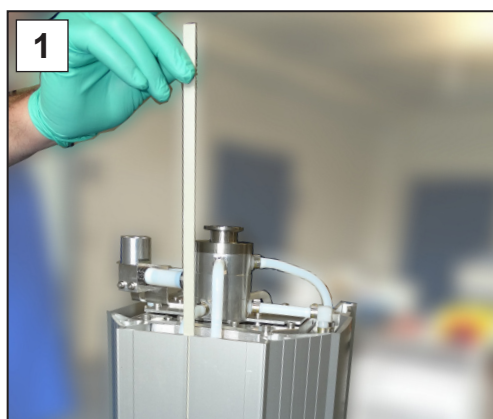
1. Insérez le listeau dans la rainure entre les panneaux latéraux.
