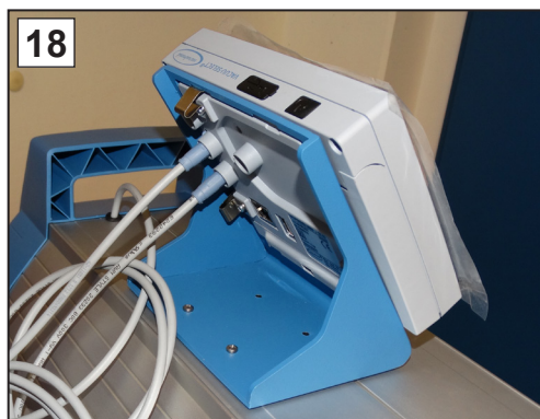
18. Fixez le régulateur sur la pompe à membrane et raccordez l'ensemble des câbles.
