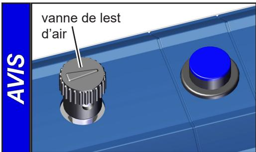
Faites fonctionner la pompe (MZ 1C) **avec lest d'air** afin de réduire la condensation des substances pompées (vapeur, solvants, ....) dans la pompe.
