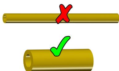
Evitez les pertes d'étranglement en utilisant des tuyaux de raccordement aussi courts que possible et à large diamètre.
