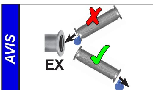
Prenez les mesures appropriées pour prévenir le reflux du condensat à partir de la conduite d'échappement vers la pompe, p.ex. en posant les conduites d'échappement en les inclinant vers le bas.
