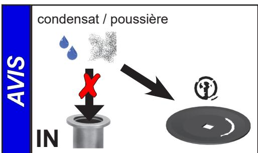
Prévenez toute condensation interne, les montées subites de vapeur ou la présence de poussière. La membrane et les clapets risquent d'être endommagés, si des liquides ou de la poussière sont pompés sur une longue période.
