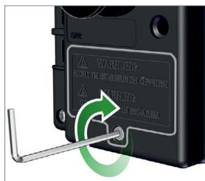
4. Remplacez le couvercle sur le vacuomètre en veillant à positionner la vis correctement, et revissez la vis fermement à la main. Lors du serrage, respecter le couple maximal de 0,4 Nm
