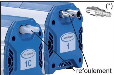
Le refoulement a lieu par un embout DN 10 mm (ME 1C, MZ 1C) ou par un silencieux (ME 1).
