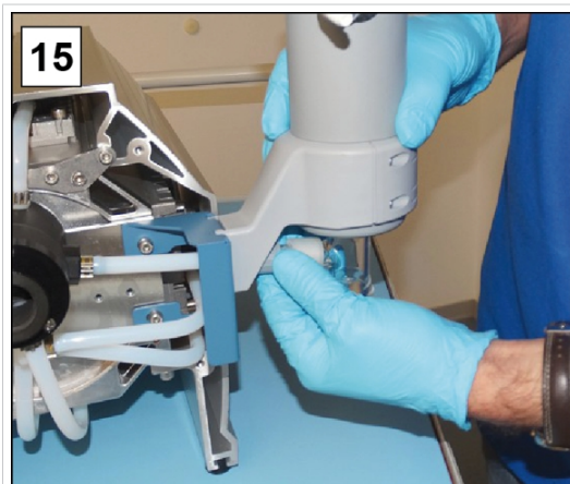
15. Fije la tuerca de unión de la alimentación del EK.
