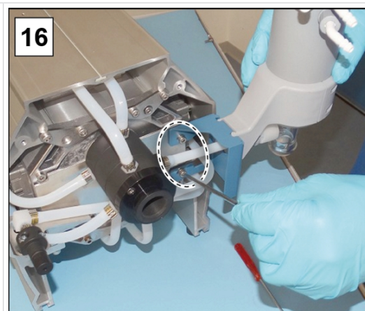
16. Apriete los 2 tornillos del soporte del EK; utilice una llave Allen del n.º 4.
