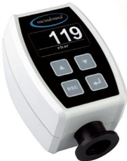
Con sensor de membrana cerámica resistente a los productos químicos para la medición precisa en el **rango de vacío bajo**. Según el principio de medición capacitivo, la presión absoluta presente se registra independientemente del tipo de gas.
