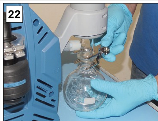
22. Fije el depósito de vidrio en la EK.
