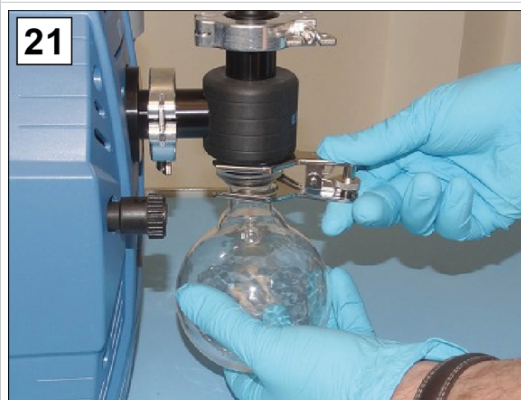
21. Fije el depósito de vidrio en la entrada IN.
