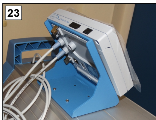
23. Fije el controlador en la estación de bombeo y conecte todos los cables.
