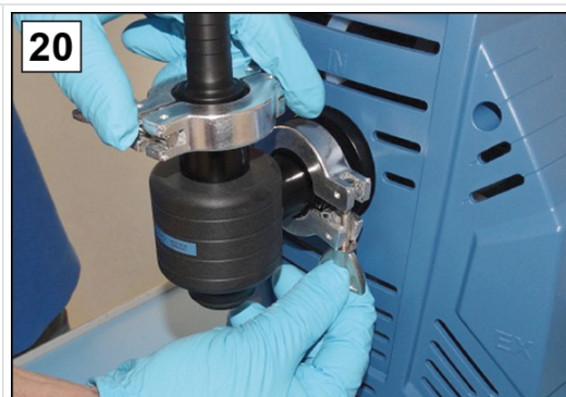
20. Fije el separador de succión con el anillo de apriete.
