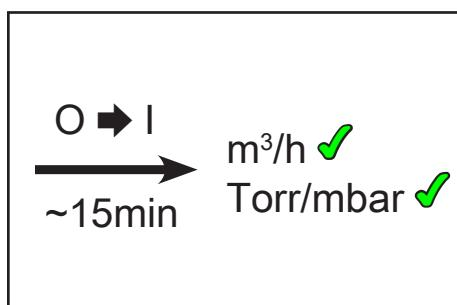
La bomba alcanza los valores introducidos para la potencia de succión y el vacío final solo a la temperatura de funcionamiento (después de unos 15 minutos).
