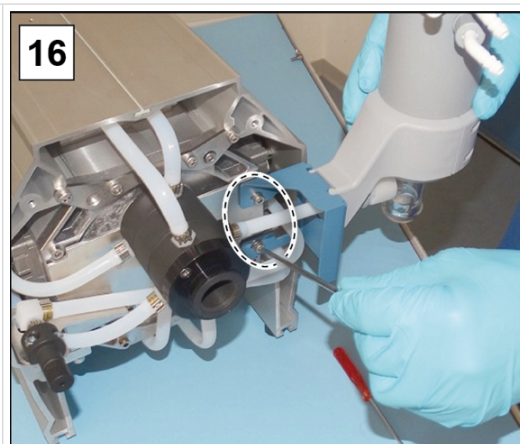
16. Drehen Sie die 2 Schrauben vom EK-Halter ein; Innensechskantschlüssel Gr. 4.
