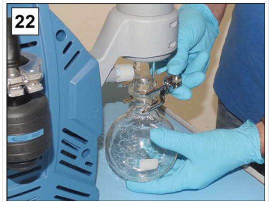
22. Fixieren Sie den Glaskolben am EK.
