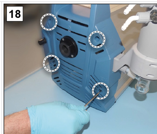
18. Drehen Sie die Schrauben vom Gehäuseteil ein; Innensechskantschlüssel Gr. 4.
