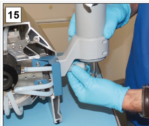
15. Fixieren Sie die Überwurfmutter vom Zulauf EK.
