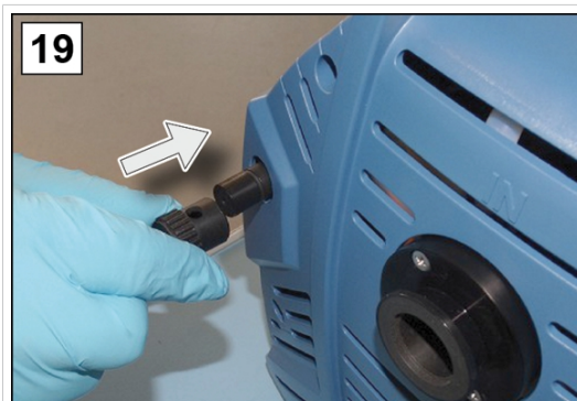
19. Stecken Sie die Kappe auf den Gasballast.
