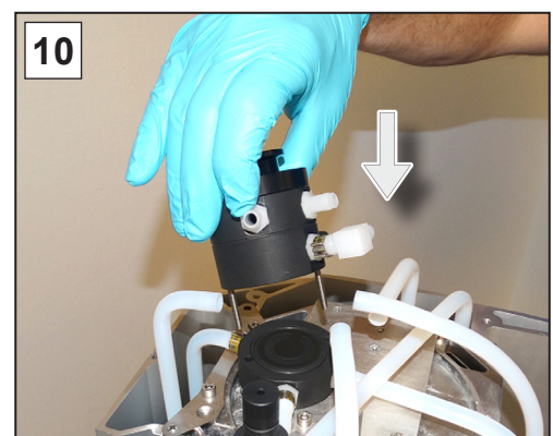
10. Setzen Sie den Saugverteiler mit den Schrauben auf und drehen Sie die Verschraubungen handfest an; Kreuzschlitzschraubendreher Gr. 2.
