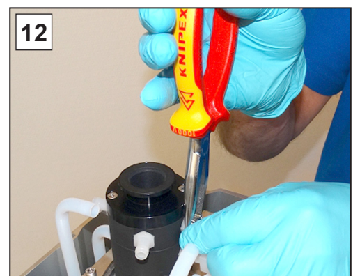
12. Schließen Sie die Schlauchschellen auf den Schlauchwellen, z. B. mit einer Flachzange.
