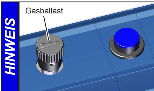
Bei Förderung kondensierbarer Dämpfe die Pumpe (MZ 1C) mit Gasballast betreiben, um die Kondensation von gepumpten Stoffen (Wasserdampf, Lösemittel,...) in der Pumpe zu verringern.
