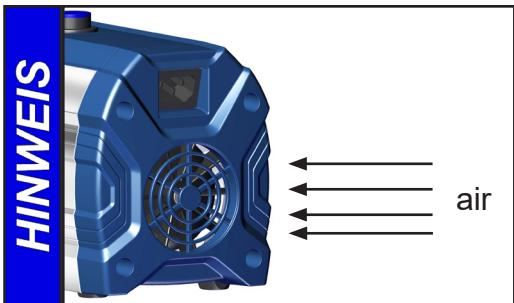
Stets eine ausreichende Luftzufuhr zum Lüfter sicherstellen. Den Lüfter regelmäßig auf Verschmutzung überprüfen. Verschmutztes Lüftergitter reinigen, um eine Einschränkung der Luftzufuhr zu vermeiden.
