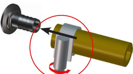
Schlauchverbindungen geeignet gegen unbeabsichtigtes Lösen sichern (z.B.: Schlauchschellen verwenden).
