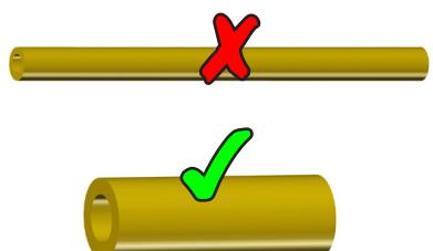
Kürzest mögliche Vakuumverbindungsleitungen großer Nennweite verwenden, um Drosselverluste zu vermeiden.
