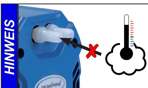
Starke Wärmezufuhr (z.B. durch heiße Prozessgase) vermeiden. Zulässiger Temperaturbereich: siehe "Technische Daten / Gasansaugtemperaturen".
