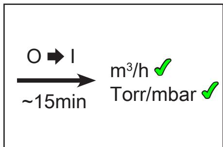
Die Pumpe erreicht die angegebenen Werte für Saugleistung und Endvakuum sowie die Dampfverträglichkeit (MZ 1C) erst bei Betriebstemperatur (nach ca. 15 min.).
