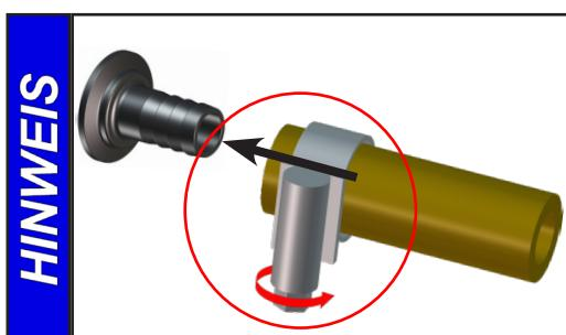
Schlauchverbindungen geeignet gegen unbeabsichtigtes Lösen sichern (z.B.: Schlauchschellen verwenden).
