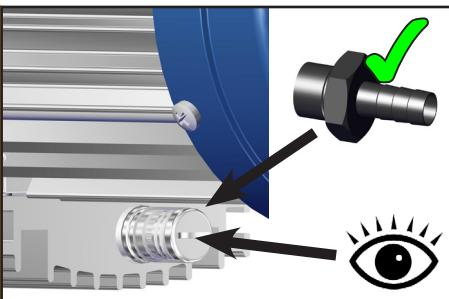
☞ Nach längerem Betrieb mit hohen Ansaugdrücken oder staubhaltigen Gasen kann der Schalldämpfer verstopfen. Den Schalldämpfer regelmäßig auf Durchlässigkeit überprüfen, ggf. austauschen oder durch eine Schlauchwelle ersetzen.
