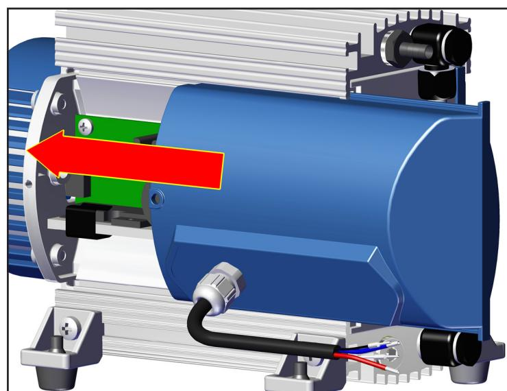
Nach Austausch der Sicherung Abdeckung wieder montieren.
