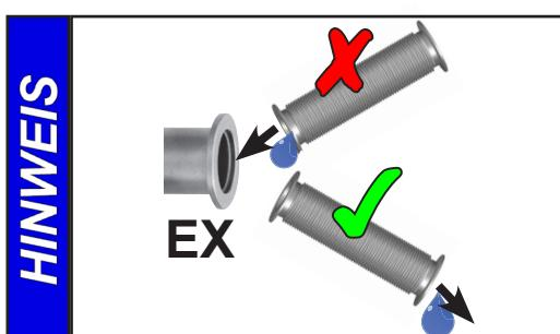
Auspuffleitungen stets fallend verlegen oder andere Maßnahmen ergreifen, um Kondensatrückfluss aus der Auspuffleitung in die Pumpe zu verhindern.
