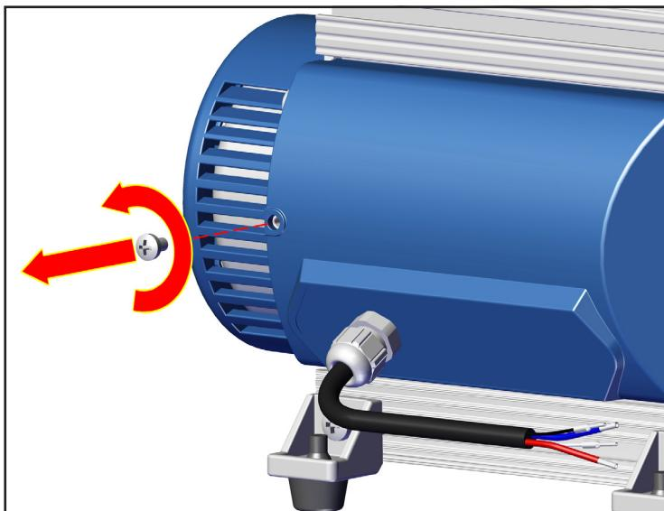
Schraube an der Abdeckung herausdrehen.
