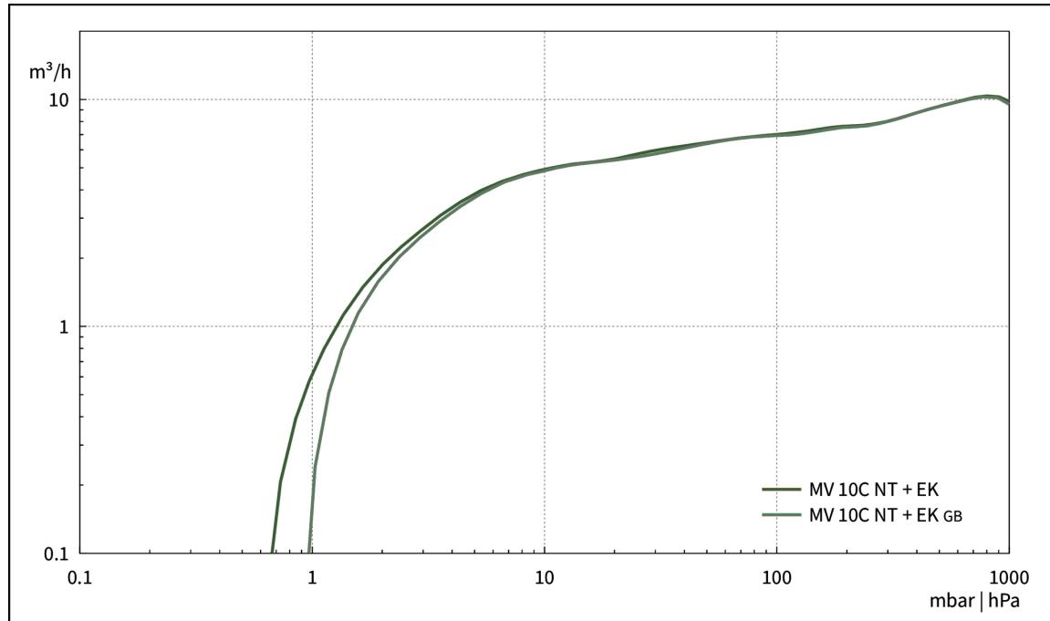
**Courbe de pompage à 50 Hz (réservoir 100l)**
