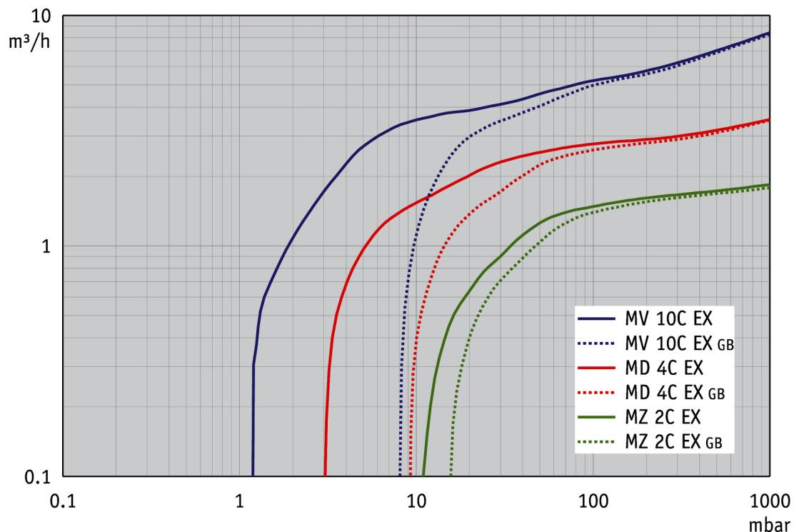
Courbe de pompage à 50 Hz (réservoir 100l)
