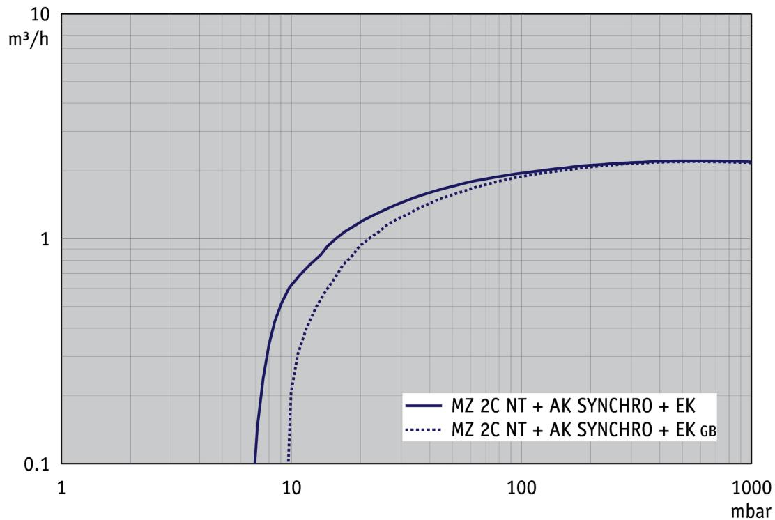
Courbe de pompage à 60 Hz (réservoir 10 l)
