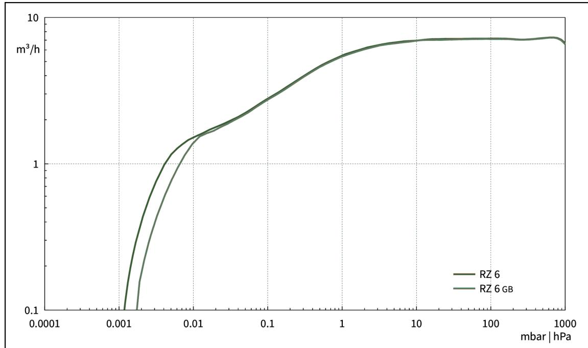
**Courbe de pompage à 60 Hz (réservoir 10 l)**
