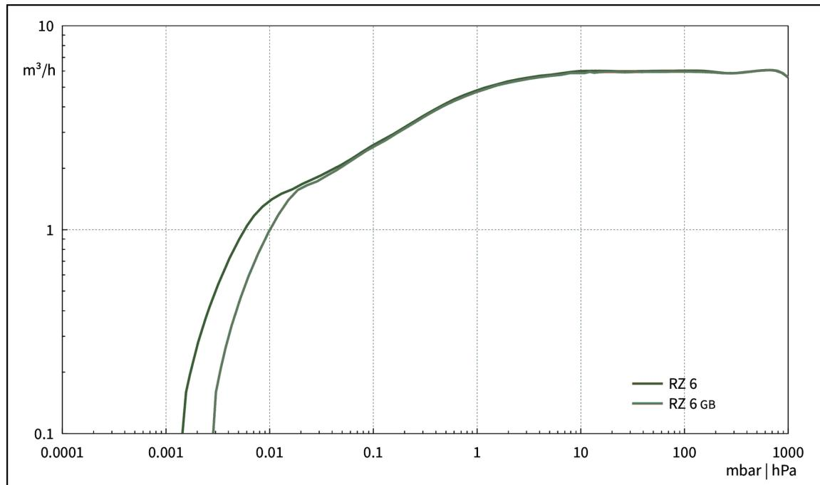
Courbe de pompage à 50 Hz (réservoir 10 l)
