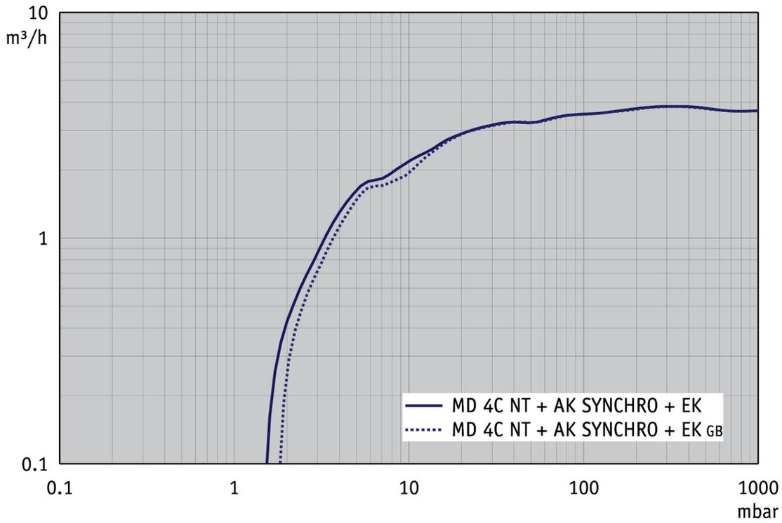
Abpumpkurve bei 60 Hz (10 l Behälter)
