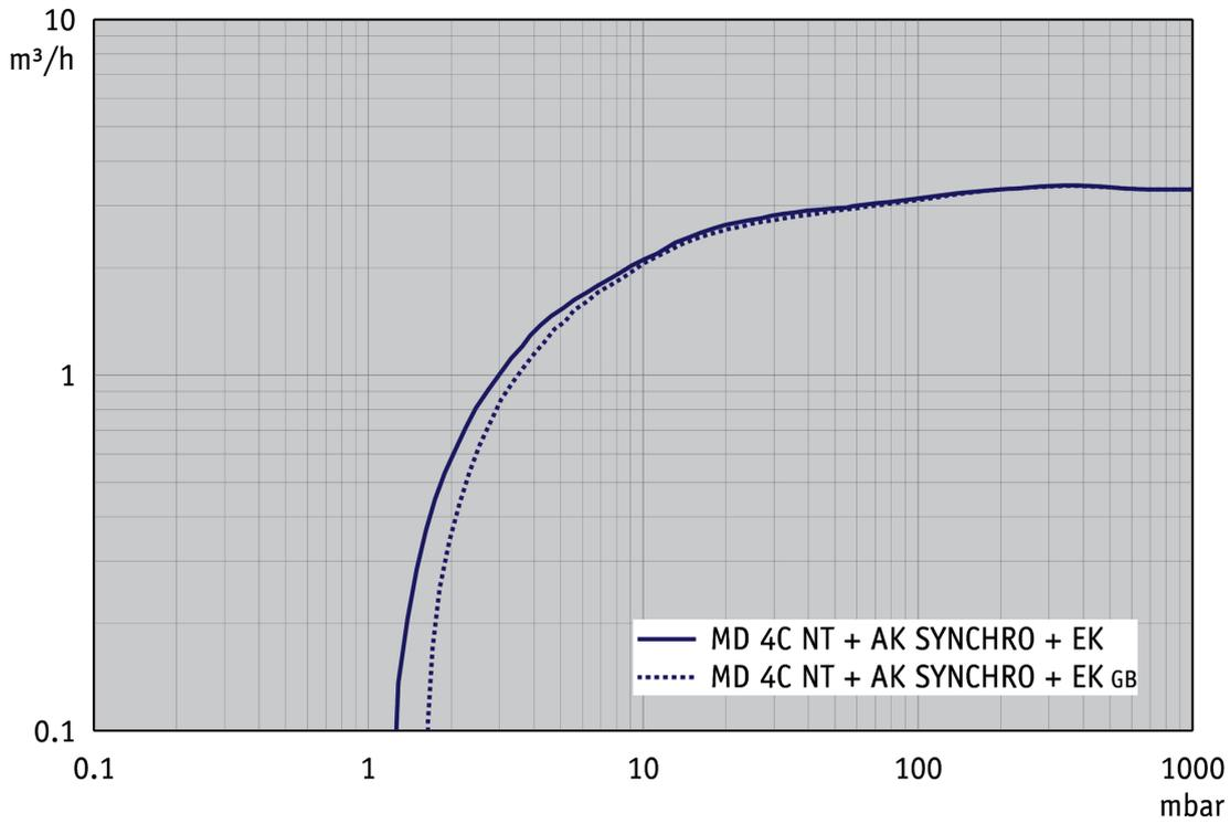
Abpumpkurve bei 50 Hz (10 l Behälter)
