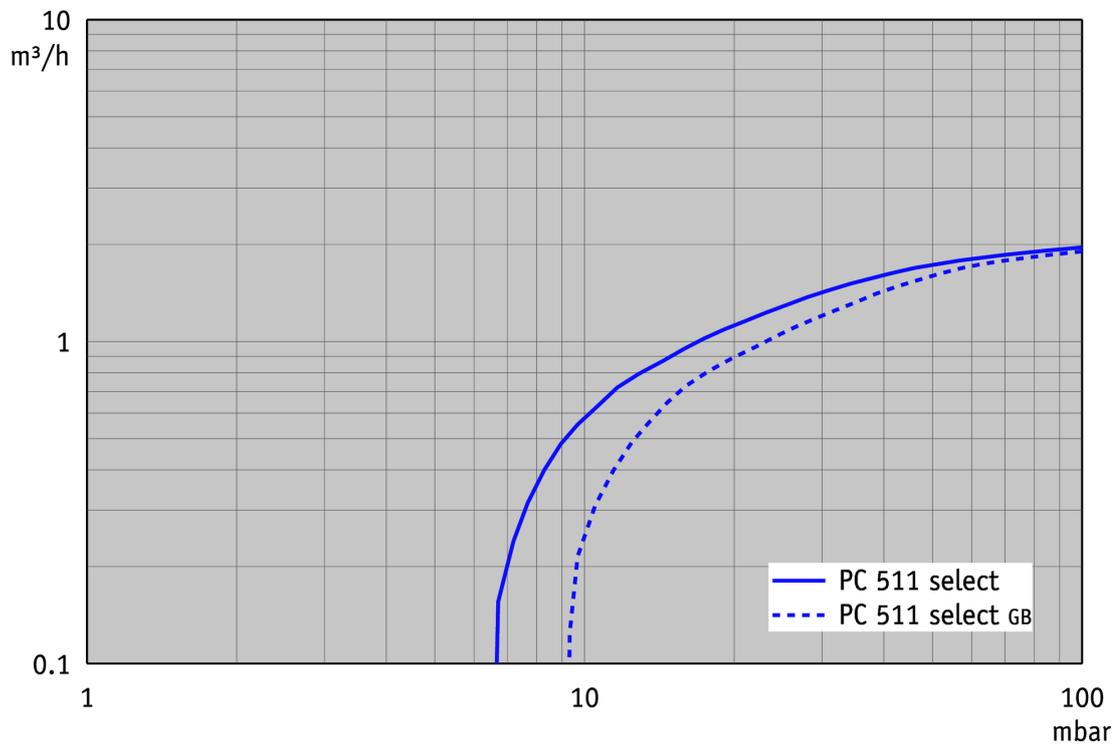
Abpumpkurve bei 60 Hz (10 l Behälter)
