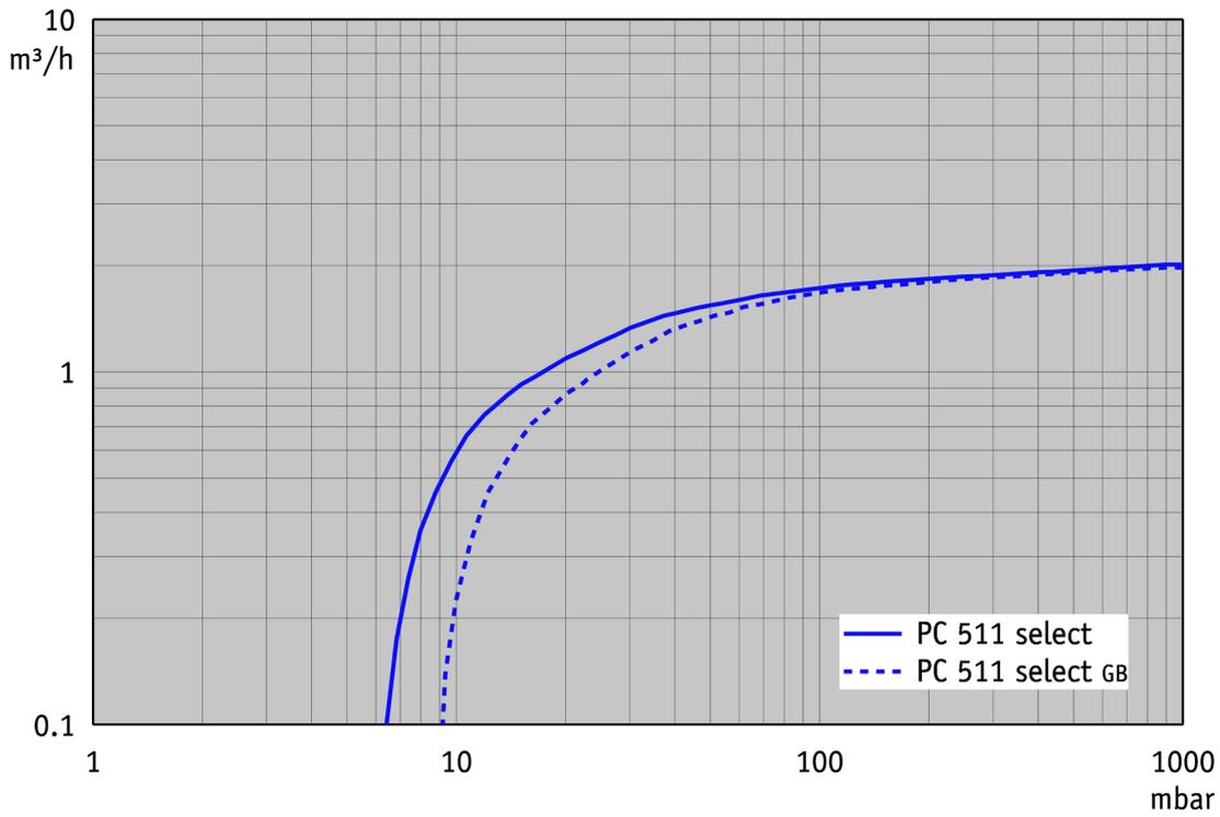
Abpumpkurve bei 50 Hz (10 l Behälter)
