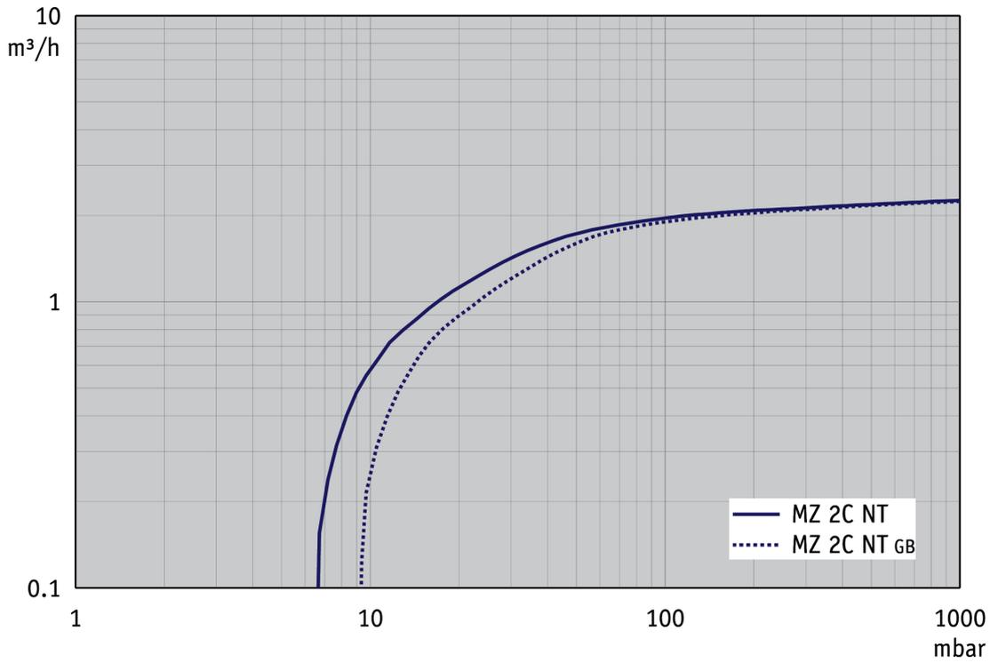
Abpumpkurve bei 60 Hz (10 l Behälter)
