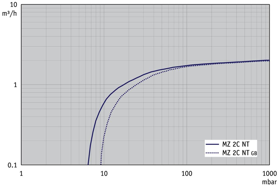
Abpumpkurve bei 50 Hz (10 l Behälter)
