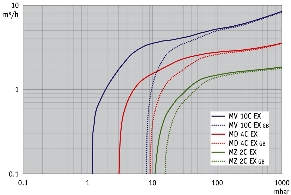
Abpumpkurve bei 50 Hz (100 l Behälter) (Evacuation curve at 50 Hz (100 l container))
