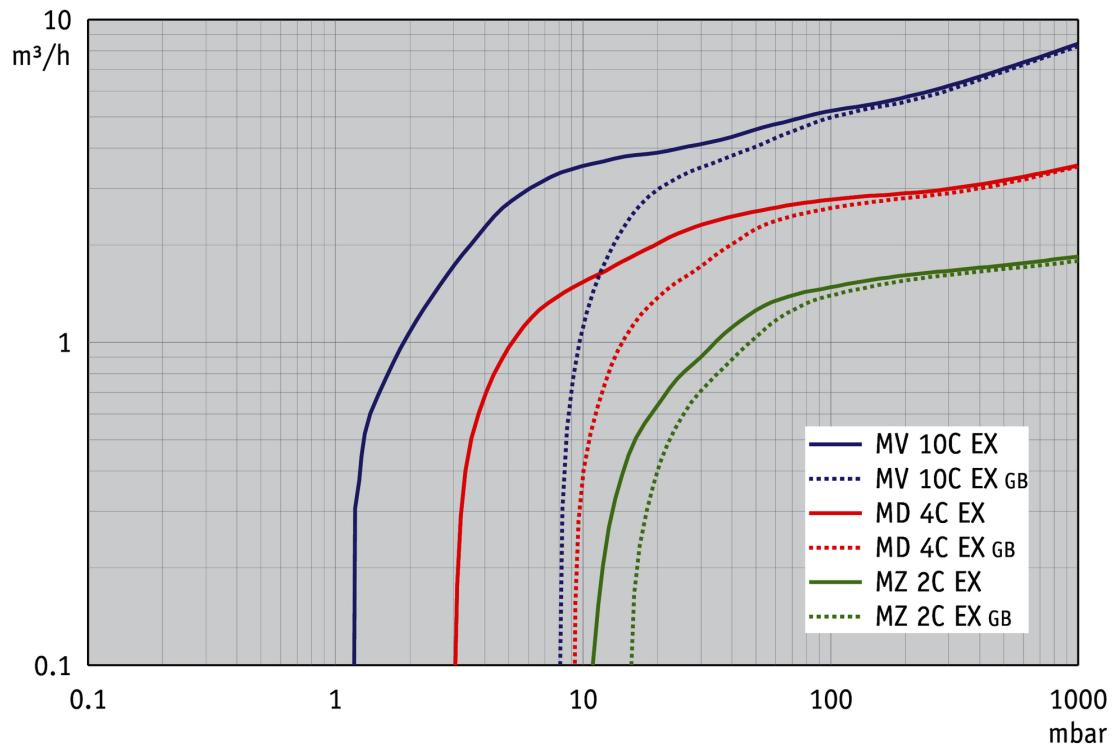
Abpumpkurve bei 50 Hz (100 l Behälter)
