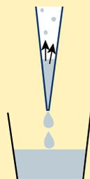
Évaporation du liquide dans le coussin d'air. Le coussin d'air se dilate et provoque la formation de gouttes.
