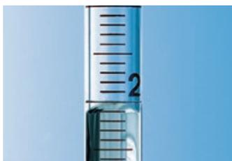
Nach oben gekrümmter Meniskus in einer Messpipette.
