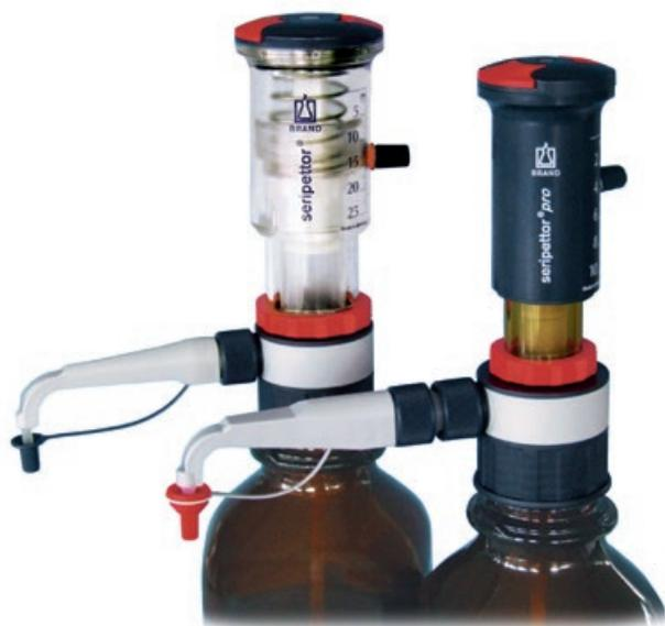
Hier ist das gesamte System so konstruiert, dass die komplette Dosiereinheit austauschbar ist. Die etwas höheren Bedienkräfte beim Füllen werden durch eine Feder mit selbsttätiger Hubwirkung minimiert. Im vorliegenden Beispiel handelt es sich um einen preisgünstigen Dispenser für einfache Dosieraufgaben im Volumenbereich von 0,2 bis 25 ml.
