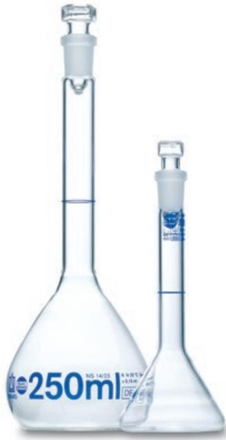
Messkolben sind auf 'In' justierte Messgeräte, Klasse A und B, die vorwiegend zum Herstellen von genauen Lösungen, z. B. Maß- und Standardlösungen, sowie zum Ansetzen von Verdünnungen verwendet werden.
