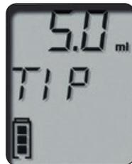
Dispenser-Tips von BRAND besitzen einen in ihren Kolben integrierten Größen-Code. Nach dem Einsetzen wird die erkannte Tip-Größe automatisch angezeigt. Das vermeidet Fehler und das zu dosierende Volumen
