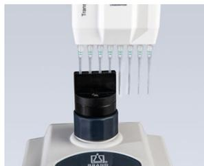
Dichtheitsprüfung mit Mehrkanal-Pipetten
