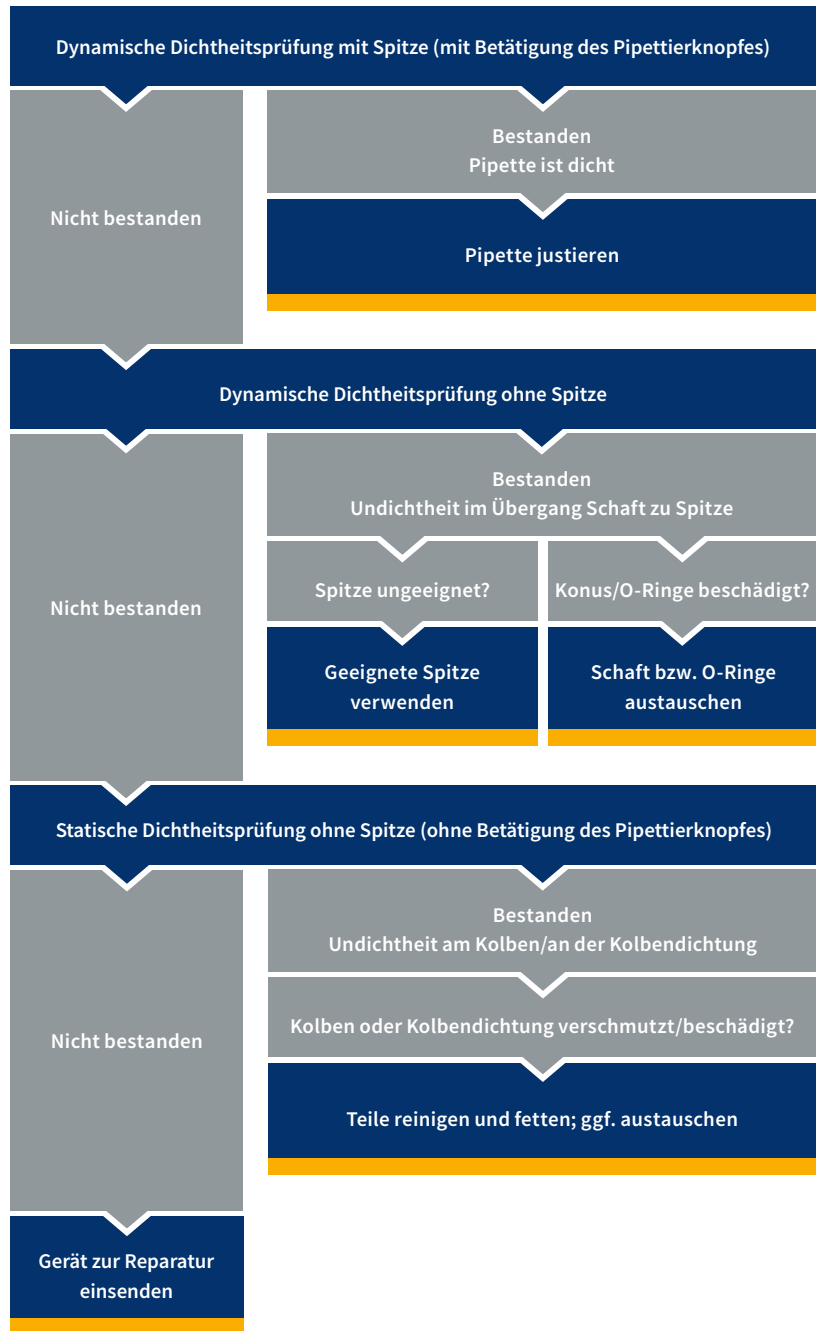
Abbildung 2 Ermittlung der Ursache für die Undichtheit mit der BRAND PLT unit
