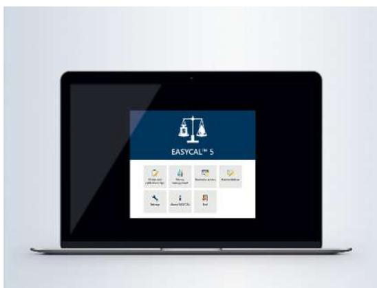
El software de calibración [EASYCAL™ 5](#) le facilita el control de instrumentos de prueba según GLP/GMP y DIN EN ISO 9001 para equipos de manipulación de líquidos (dispositivos de émbolo como pipetas, dispensadores, buretas y dispensadores manuales), así como de equipos de medición de volumen de vidrio o plástico. EASYCAL™ 5 no solo se puede usar con equipos BRAND, sino también con instrumentos de otros fabricantes.
