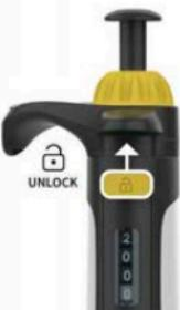
b. 在所示方向上顶着轻微阻力推动体积调整保护装置。
