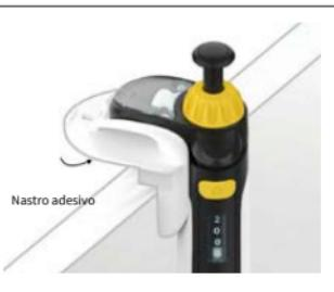
È possibile agganciare la Transferpette® pro -8/-12 nel supporto o nel montante anche con la staffa di appoggio per le dita spostata.
