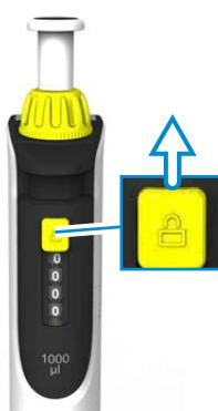
a. Volumenverstellschutz nach oben schieben (UNLOCK).
