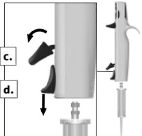
c. Balançar a alavanca de bloqueio/enchimento para a frente (isto desacopla o pistão).
