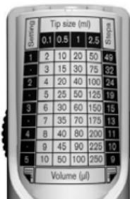
装置背面の表は両面印刷されています。交換するにはチップを押し上げ、表を裏返し、透明チップを再度押し戻します。
