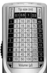
Tabellen på enhetens baksida är tryckt på båda sidor. För att växla: skjut upp clipset, vänd tabellen och skjut tillbaka det transparenta clipset.
