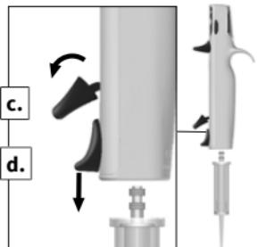
c. Sväng ut spärr-/fyllningsspaken framåt (kolven kopplas då loss).
