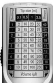
Tabulka na zadní straně přístroje je oboustranně potištěná. Pro výměnu vysuňte příchytku nahoru, otočte tabulkou a opět průhlednou příchytku zasuňte.
