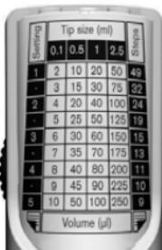
De tabel op de achterkant van het apparaat is dubbelzijdig bedrukt. Om deze om te draaien, de clip omhoog schuiven, de tabel omdraaien en de doorzichtige clip weer terugschuiven.
