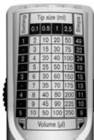
仪器背面的双面打印表格。若要更换，请向上推开夹子，翻转表格，然后再重新推回透明夹子。
