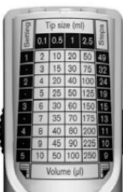
Таблица на задней стороне аппарата напечатана с обеих сторон. Для замены сдвиньте вверх зажимной элемент, переверните таблицу и верните в исходное положение прозрачную часть корпуса.
