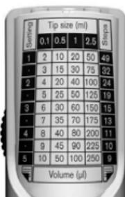
Le tableau au dos de l'appareil est imprimé sur les deux faces. Pour le remplacement, relever le clip, retourner le tableau et ré-insérer le clip transparent.
