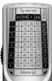
La tabla en la parte posterior del equipo está impresa de ambos lados. Para cambiar, empujar el clip hacia arriba, dar vuelta la tabla y volver a colocar el clip transparente.
