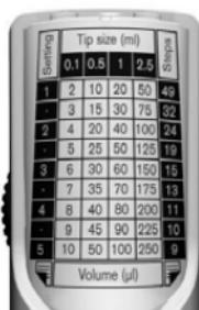
La tabella sulla parte posteriore dello strumento è stampata sui due lati. Per cambiare lato, spingere il fermaglio verso l'alto, girare la tabella e reinserire il fermaglio trasparente.
